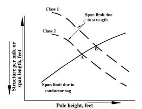
FIGURE 13-1: SELECTION OF LEVEL GROUND SPAN
